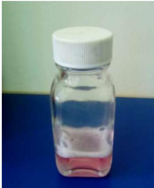
6.3.4 Con el gotero agregar 1 gota de solución de Titration y mezclar, se deberá contar el número de gotas hasta que se cambie a un color azulado.
