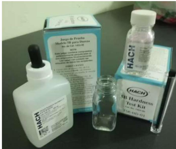
6.3.3 Agregar la muestra de agua al frasco y asimismo agregar una porción (cuchara negra) del reactivo de dureza y mezclar, la muestra se tornara de color rosado.
