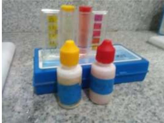
6.3.3 agregar 4 gotas de ortotolidina al tubo amarillo (colorimetría de cloro) y agregar 4 gotas de rojo de fenol al tubo rojo (colorimetría pH)
